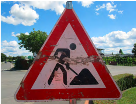
Stark beschädigte Folie des Verkehrszeichens „Arbeitsstelle“ (VZ 123). Foto: Haardt, BG BAU
