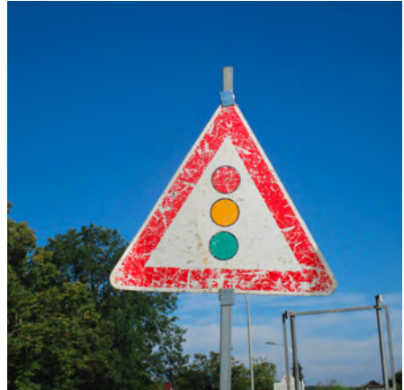
Stark beschädigte Folie des Verkehrszeichens „Lichtzeichenanlage“ (VZ 131). Foto: Haardt, BG BAU
