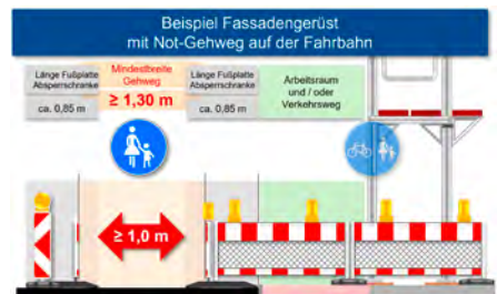
Querabspernung / Kennzeichnung eines Gerüsts mit Arbeitsraum auf einem getrennten Geh- und Radweg nach Regelplan B II / 7 Abbildung: Langer, BG BAU
