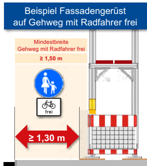
Querabspernung/Kennzeichnung eines Gerüsts ohne Arbeitsraum neben dem Gerüst
