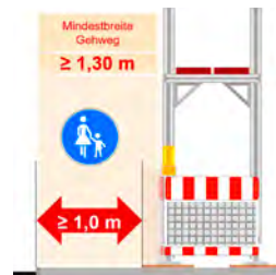
Querabsperzung/Kennzeichnung eines Gerüstes ohne Arbeitsraum neben dem Gerüst
