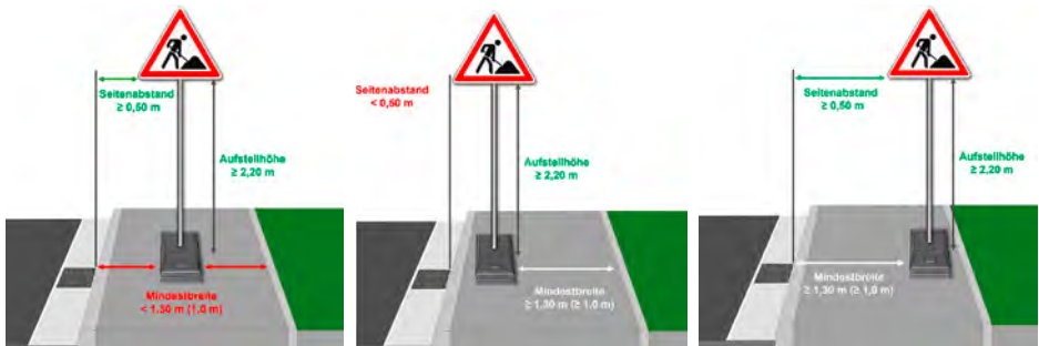
Darstellung der zu beachtenden Maße bei der Aufstellung von Verkehrszeichen. Auch an Arbeitsstellen gilt, dass vertikale Verkehrszeichen gut sichtbar, stand- und verdrehsicher sowie grundsätzlich senkrecht zur Fahrbahn und rechtwinklig zur Verkehrsrichtung aufgestellt werden müssen. Abbildung: Langer, BG BAU
